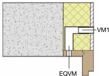
Incorporé dans le doublage ou le gros œuvre au-dessus de la menuiserie, le manchon équerre est associé côté intérieur à un manchon VM1 et une entrée d'air VM-G, côté extérieur à une grille de façade GPVM.
