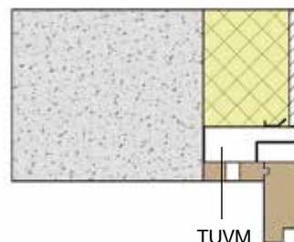
Fixé en partie haute de la menuiserie avant la pose du doublage, le manchon tunnel est associé côté intérieur à une entrée d'air VM-G et côté extérieur à une grille de façade GPVM.
