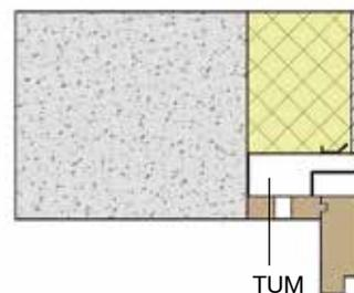
Fixé en partie haute de la menuiserie avant la pose du doublage, le manchon tunnel est associé côté intérieur à une entrée d'air M-G et côté extérieur à une grille de façade GPE2A.
