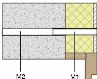
Le manchon fixe M2 s'installe en traversée de mur et le manchon de réglage M1 en traversée de doublage. L'ensemble est installé avec une légère pente vers l'extérieur pour éviter toute intrusion d'eau.
