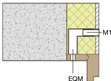
Incorporé dans le doublage ou le gros œuvre au dessus de la menuiserie, le manchon équerre est associé côté intérieur à un manchon M1 et une entrée d'air M-G, côté extérieur à une grille de façade GPE2A.
