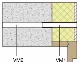
Le manchon fixe VM2 s'installe en traversée de mur et le manchon de réglage VM1 en traversée de doublage. L'ensemble est installé avec une légère pente vers l'extérieur pour éviter toute intrusion d'eau.
