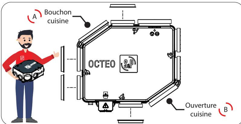
Mettez en place les bouchons sanitaires Ø 80 nécessaires, selon votre installation, pour ne laisser que les orifices destinées à accueillir les piquages d'extraction OCTEO® POWERTWIST Ø 80. Le bouchon cuisine Ø 125 est déjà positionné.
