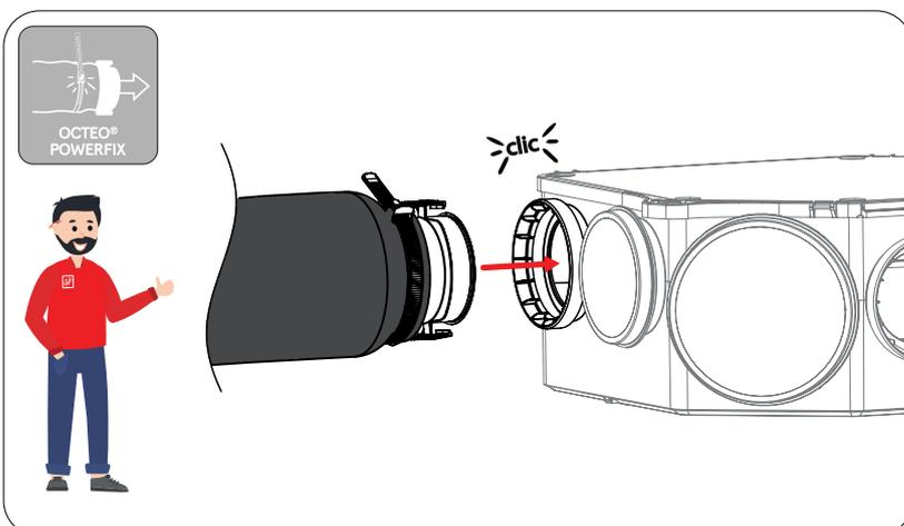
Vous pouvez connecter au caisson OCTEO HYGRO ECOWATT tous les piquages flexibles OCTEO® POWERWIST ainsi que le piquage de refoulement (rejet). Exercez une légère pression, jusqu'à entendre le "clac" garantissant la connexion et l'étanchéité entre les deux éléments.
