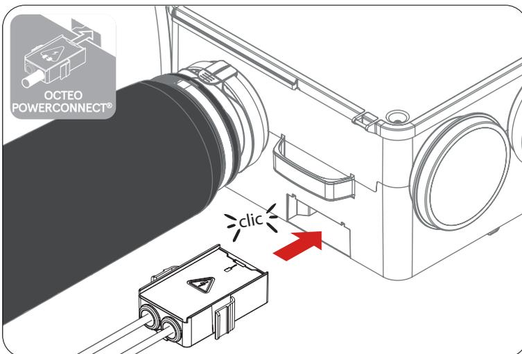
Vous pouvez à présent raccorder électriquement votre groupe d'extraction OCTEO HYGRO ECOWATT au réseau en clipsant le connecteur électrique OCTEO® POWERCONNECT.
