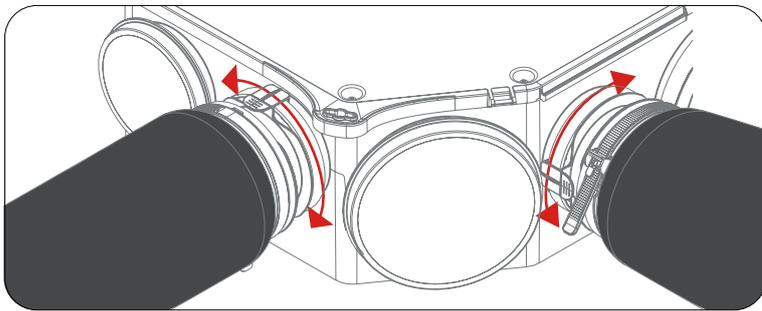
Gardez le contrôle sur l'orientation de votre réseau de gaines et procédez aux ajustements en faisant simplement pivoter le piquage OCTEO® POWERWIST autour de son axe sans le déclipser.
