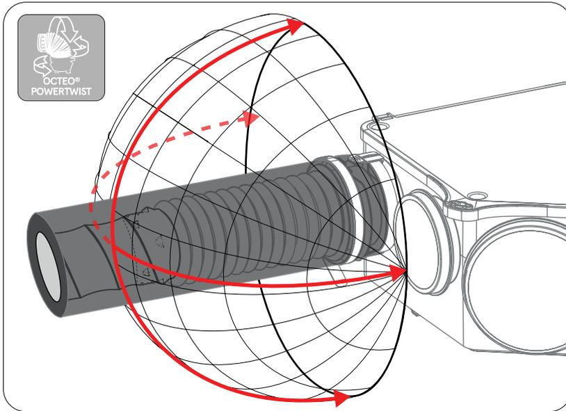
Utilisez le système breveté de chaque piquage OCTEO® POWERTWIST pour orienter chacune de vos gaines vers les bouches. L'objectif étant de limiter au maximum l'angle à la sortie du caisson et le nombre de coudes dans votre réseau; tout en préservant le diamètre nominal de la gaine.
