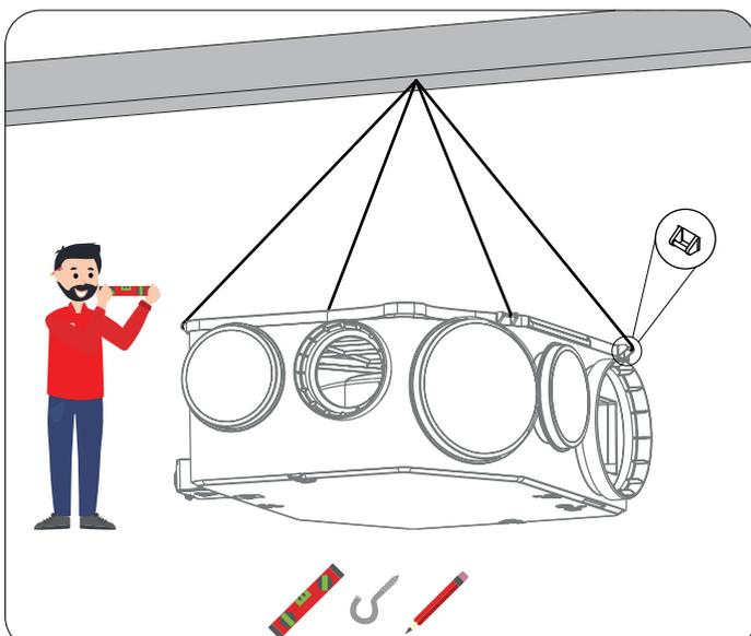
**Pour un montage en suspension (combles),** utilisez la cordelette fournie sur vos fermettes ou sur un crochet (non inclus) pour suspendre votre OCTEO HYGRO ECOWATT grâce aux 4 taquets situés sur le couvercle supérieur. Assurez-vous de l'horizontalité de votre installation, à l'aide d'un niveau à bulle.
