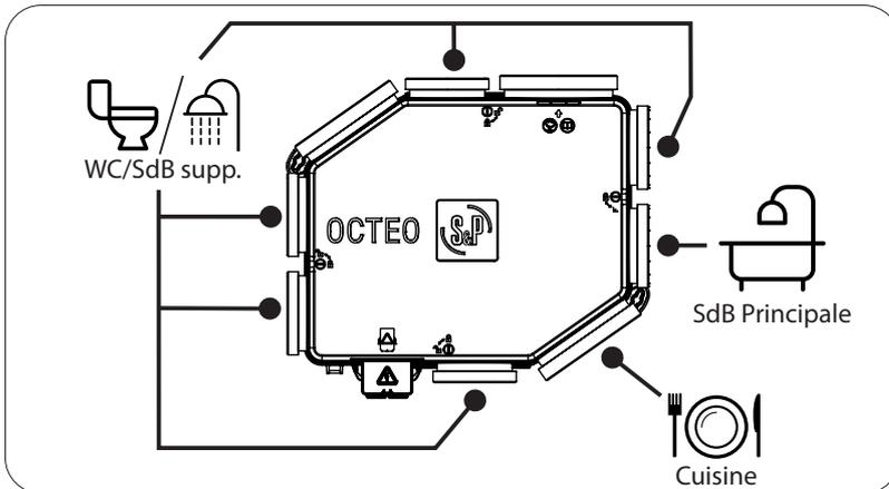
Positionnez votre OCTEO HYGRO ECOWATT dans votre logement (combles ou faux-plafond), en orientant les orifices de l'OCTEO HYGRO ECOWATT vers les pièces humides comme indiqué sur le schéma (ex : orifice cuisine vers bouche cuisine Ø 125).
