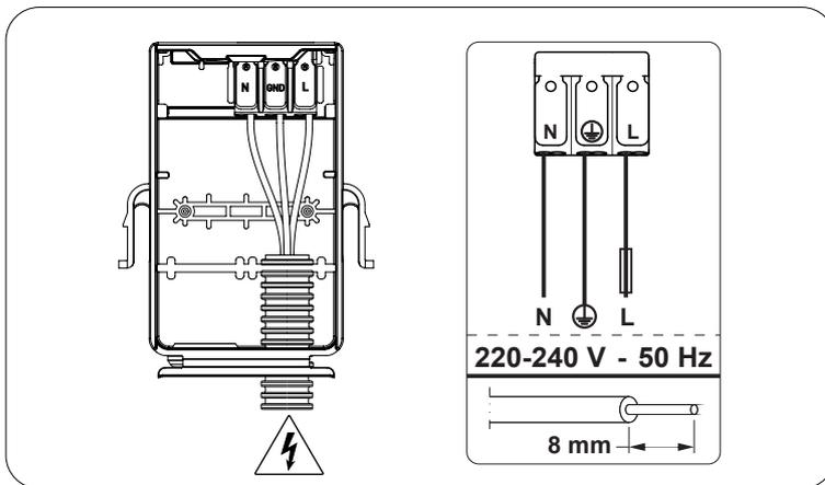
Veillez à faire correspondre les Phase (L) et Neutre (N) de votre réseau électrique avec les fiches de connexion rapide, comme indiqué sur le schéma.
