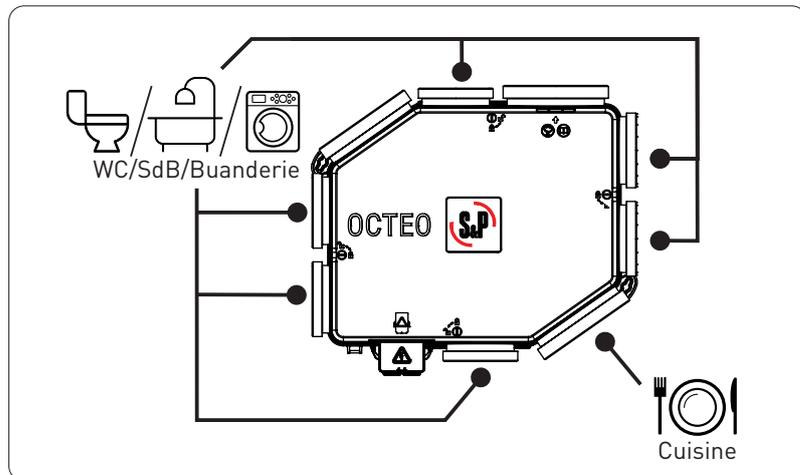
Positionnez votre OCTEO HYGRO ECOWATT+ dans votre logement (combles ou faux-plafond), en orientant les orifices de l'OCTEO HYGRO ECOWATT+ vers les pièces humides comme indiqué sur le schéma (ex : orifice cuisine vers bouche cuisine Ø125).
