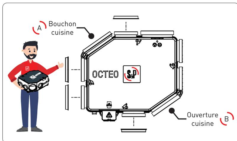
Mettez en place les bouchons sanitaires Ø80 nécessaires, selon votre installation, pour ne laisser que les orifices destinés à accueillir les piquages d'extraction OCTEO® POWERWIST Ø80. Le bouchon cuisine Ø125 est déjà positionné.
