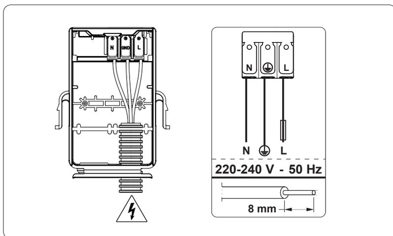
Veillez à faire correspondre les Phase (L), Neutre (N) et Terre (⊕) de votre réseau électrique avec les fiches de connexion rapide, comme indiqué sur le schéma.
