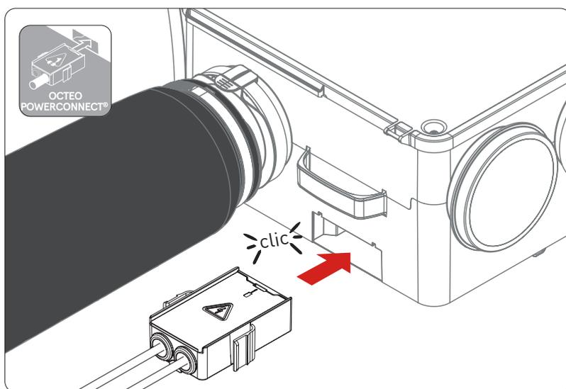
Vous pouvez à présent raccorder électriquement votre groupe d'extraction OCTEO HYGRO ECOWATT+ au réseau en clipsant le connecteur électrique OCTEO® POWERCONNECT. Si votre groupe est suspendu en combles, utilisez la poignée pour stopper l'effet balancier. Vous ne pouvez pas vous tromper de sens, suivez les dessins et les guides sur le produit pour insérer le connecteur.
