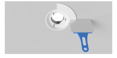
4 . L'espace entre le corps du diffuseur et la plaque de plâtre doit être comblé avec du mastic.
