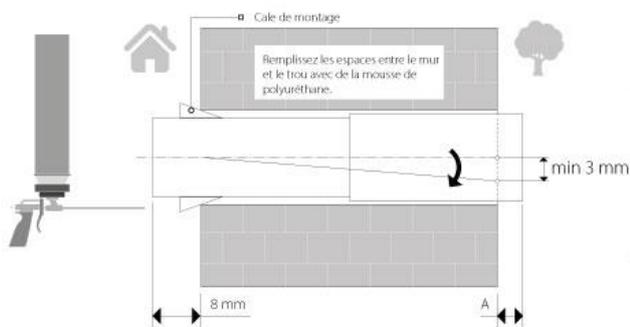
Insérez le conduit d'air dans le mur comme indiqué sur l'image de gauche. Installez le conduit d'air avec une pente minimale de 3 mm vers la rue.
