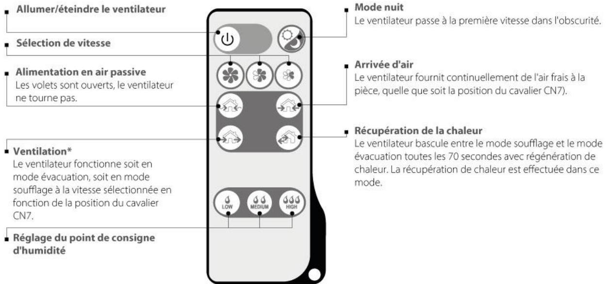
\*Lorsqu'ils sont connectés en série, les ventilateurs fonctionnent en fonction de la position du cavalier permettant de régler le mode Ventilation sur la carte de commande. Le réglage du mode Ventilation est décrit à la page 10.
