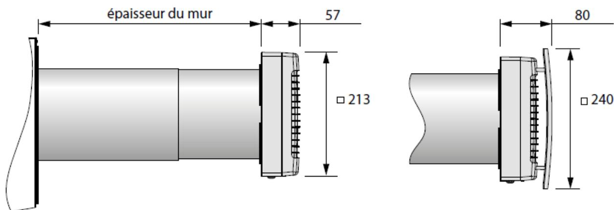
Le ventilateur se compose d'une unité intérieure avec un panneau avant décoratif, un conduit d'air télescopique et une hotte de ventilation extérieure. Deux filtres, deux redresseurs de débit d'air et un régénérateur en céramique sont installés dans le conduit intérieur du conduit d'air télescopique. Les filtres à air sont conçus pour purifier l'air soufflé et empêcher la pénétration de corps étrangers dans l'échangeur thermique et le ventilateur.
