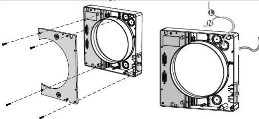
4. À l'aide du gabarit en carton fourni, marquez les trous de fixation du ventilateur comme indiqué sur la figure ci-dessous. Percez les trous et insérez les chevilles. Installez l'unité de plaque de montage sur le mur, tout en posant un joint d'étanchéité en dessous, fixez l'unité avec les vis autotaraudeuses du kit de montage. Réinstallez la plaque de montage avec les connecteurs en place et fixez-la avec quatre vis.
