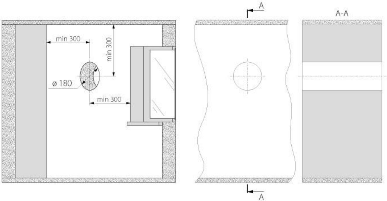
2. Insérez le conduit d'air dans le mur. Pour faciliter l'installation, utilisez les cales de montage incluses dans le kit de livraison. L'extrémité du conduit d'air doit dépasser de la distance A permettant l'installation d'une hotte de ventilation extérieure. La distance A est indiquée dans les instructions d'installation de la hotte de ventilation.
