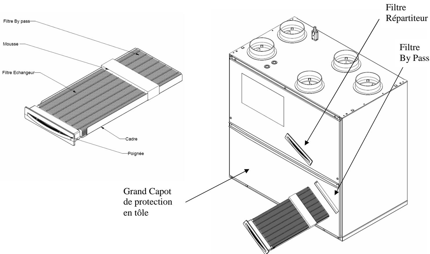
**Attention:** L'entretien courant de votre Duolix MAX (changement des filtres) ne nécessite en aucun cas le démontage du grand capot de protection présentant l'autocollant avec un éclair.
