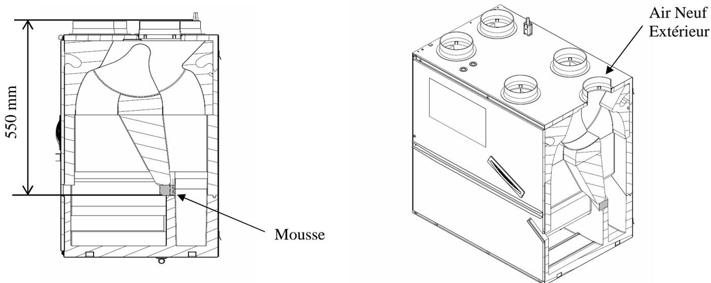
**Attention:** N'utiliser aucun objet (tranchant ou coupant) pour soustraire la mousse.
