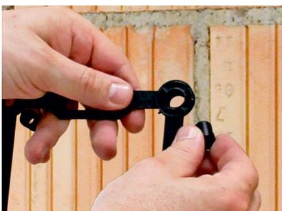
Estrarre alla base le spine di posizionamento, rompere le quattro boccole e infilare le spine nei fori della base.
