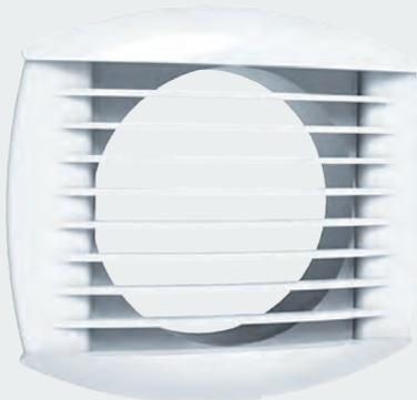
Entièrement réalisées en polystyrène, le terminal TP 125 se monte directement dans le conduit rigide Ø 125 mm, un joint assurant alors le maintien et l'étanchéité ou associée à un manchon placo 3 griffes ou à un manchon de traversée de dalle (voir ensembles ci-contre)
