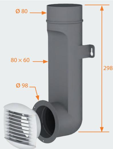
L'ensemble est destiné à être installé derrière une cloison, la bouche étant placée à environ 20 cm du plafond. Le manchon coudé réalisé en matière plastique est équipé de deux pattes de fixation. Sa forme et ses dimensions facilitent le montage sur paroi verticale. Une collerette assure la fixation de la bouche qui vient simplement s'emboîter.
