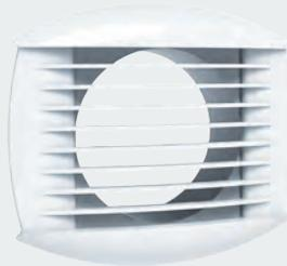
Entièrement réalisées en polystyrène, le terminal TP 80 se monte directement dans le conduit rigide Ø 80 mm, un joint assurant alors le maintien et l'étanchéité ou associée à un manchon placo 3 griffes, à un manchon de traversée de dalle ou un manchon coudé (voir ensembles ci-contre)
