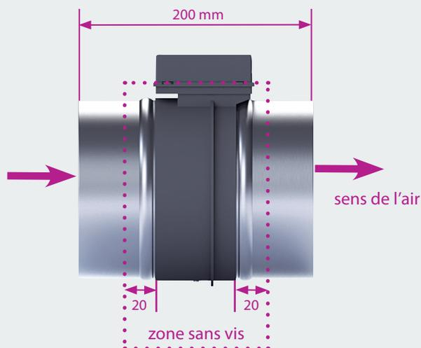
Ne pas mettre de vis dans le corps plastique et à moins de 20 mm de chaque côté de ce dernier (risque de blocage du volet). Au delà de cette zone, la longueur des vis sera de 20 mm maxi.
