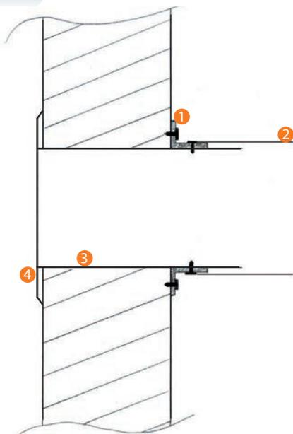
L'ensemble platine + manchon est posé en traversée de mur. La manchette de fixation, à la fois fixée sur le mur et sur le manchon vient prendre en étau cet ensemble. Le conduit est ensuite raccordé sur la manchette.
