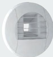
Les bouches cuisine assurent un débit modulé suivant l'humidité relative ambiante de la pièce et un débit complémentaire temporisé (30 minutes) dont l'ouverture est commandée par l'utilisateur.
