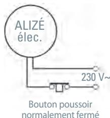
La bouche est alimentée en 230 V~. Le débit maxitemporisé est commandé soit par un bouton poussoir normalement fermé (à ouverture) soit par télécommande.
