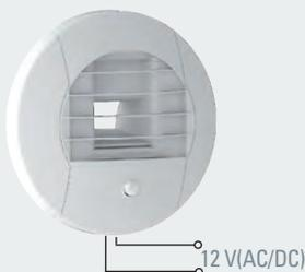
**Principe :** la bouche est alimentée par un câble 2 fils ( $2 \times 1,5 \text{ mm}^2$ ) à encaster débouchant à l'arrière de la platine support (schéma ci-contre). Prévoir un transformateur 12 V(AC/DC), 1 A, au tableau électrique.
