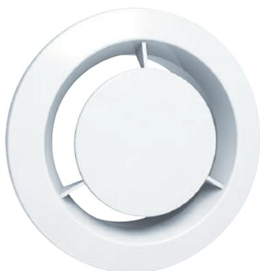
Entièrement réalisées en polystyrène, la bouche **BC 125** se monte directement dans le conduit rigide Ø 125 mm, un joint assurant alors le maintien et l'étanchéité ou associée à un manchon placo 3 griffes ou à un manchon de traversée de dalle (voir ensembles ci-contre)
