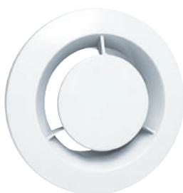
Entièrement réalisées en polystyrène, la bouche **BS 80** se monte directement dans le conduit rigide Ø 80 mm, un joint assurant alors le maintien et l'étanchéité ou associée à un manchon placo 3 griffes, à un manchon de traversée de dalle ou un manchon coudé (voir ensembles ci-contre)
