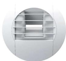
Les bouches CO<sub>2</sub> assurent un débit d'extraction de 10 à 100m<sup>3</sup>/h sous 80 Pa en fonction du taux de CO<sub>2</sub> présent dans le local où elles sont installées.
