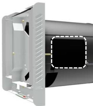
5. Retirer le couvercle en PVC de la platine de commande sur le côté du passage du câble plat en le sortant de la rainure du boîtier en EPP et enlever avec précaution le câble plat du raccord enfichable UI X9 de la platine de commande en le saisissant par le connecteur.
