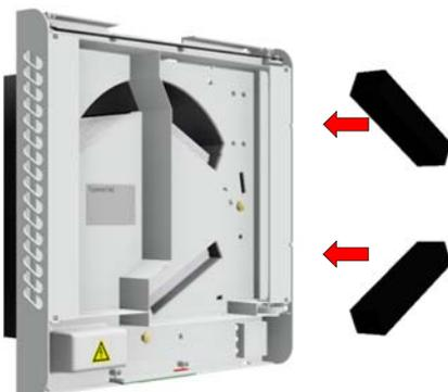
8. Placer la coiffe supérieure sur la coiffe inférieure du cache intérieur et appuyer dessus dans la zone des assemblages par encliquetage jusqu'à ce qu'ils s'enclenchent de manière audible.
