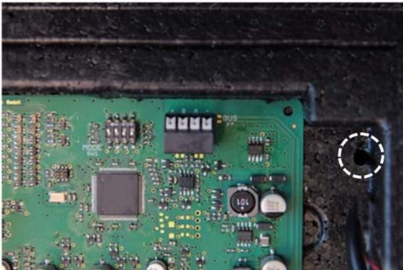
7. Guider le câble des capteurs avec les extrémités des fils de l'intérieur vers l'extérieur à travers le passage de câble du boîtier en EPP et enfoncer le câble des capteurs dans la rainure de câble.
