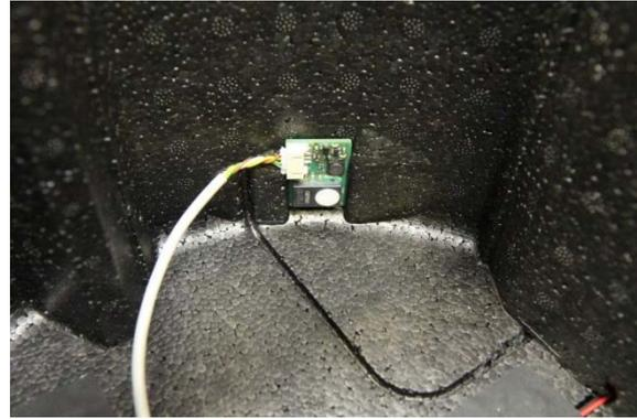
6. Retirer le bouchon à passage de câble dans la zone de la platine de commande du boîtier en EPP.
