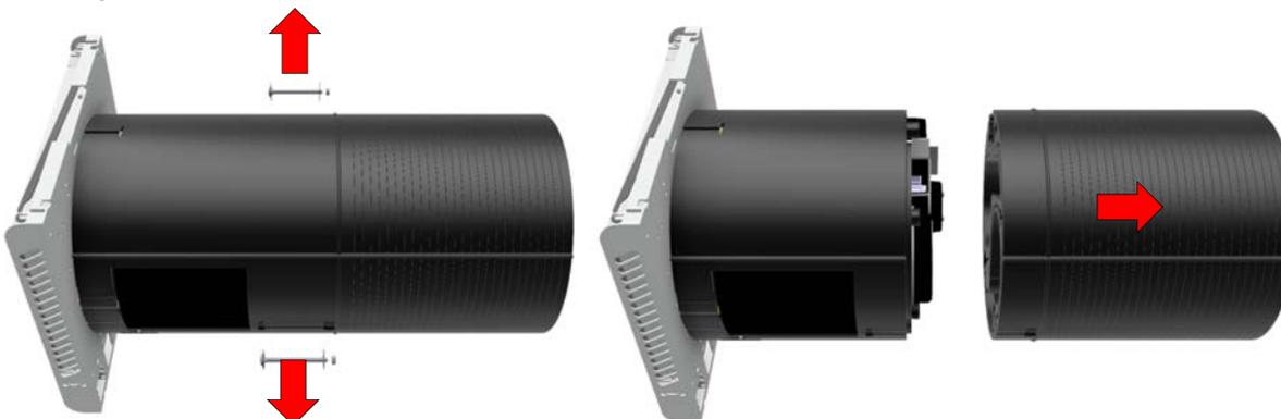
5. Retirer le couvercle en PVC de la platine de commande sur le côté du passage du câble plat en le sortant de la rainure du boîtier en EPP.
