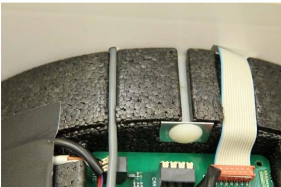
6. Après insertion de l'appareil dans le tube de montage mural, assembler l'élément du raccord enfichable du câble de raccordement et l'élément du raccord enfichable du câble de l'interface de commande externe.
