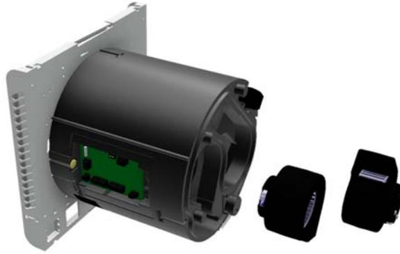
6. Les ventilateurs de construction identique peuvent, après débranchement des câbles des ventilateurs des bornes FAN1 X4 et FAN2 X3 de la platine de commande, être retirés en les guidant en même temps hors du boîtier en EPP. Ce faisant, ne pas endommager les bandes d'étanchéité dans la zone des ventilateurs.
