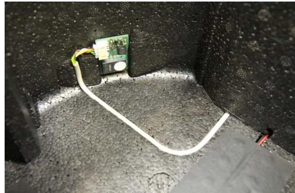
8. Connecter le câble des capteurs au point de serrage SENSOR X8 de la platine de commande.
