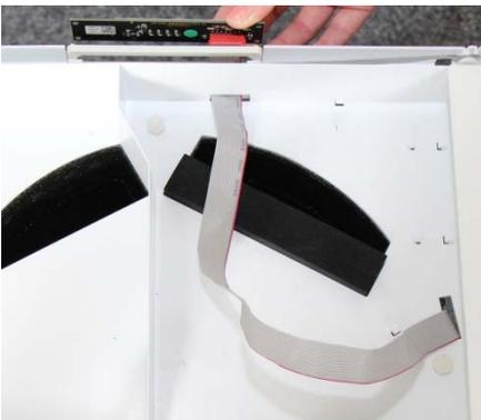
6. Poser le câble plat dans les points de fixation prévus en veillant à un léger chevauchement dans la zone des angles à 90°. Encliqueter ensuite la feuille de commande dans la position adéquate sur le support de l'interface de commande.
