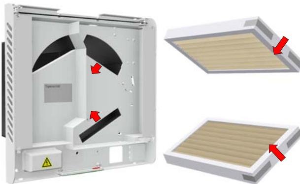
7. Remettre les couvercles de filtre en place, de sorte que le compartiment de filtre soit uniformément fermé.
