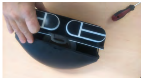
Remettre la façade dans l'autre sens
