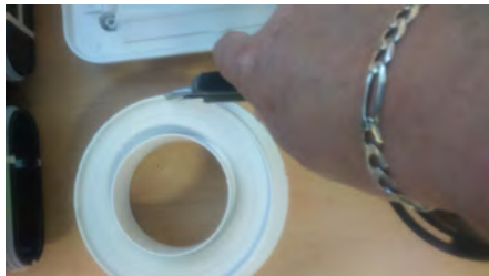
Découper le support en suivant le marquage
