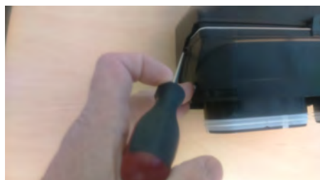
Déclipser le côté de la façade piquages
