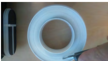
Découper le support en suivant le marquage
