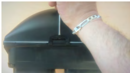
Déclipser le dessus de la façade piquages
