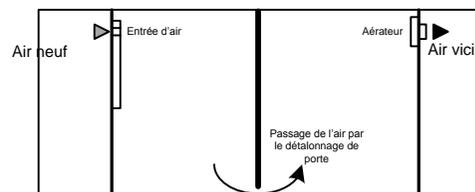
**Principe d'installation par Balayage**
