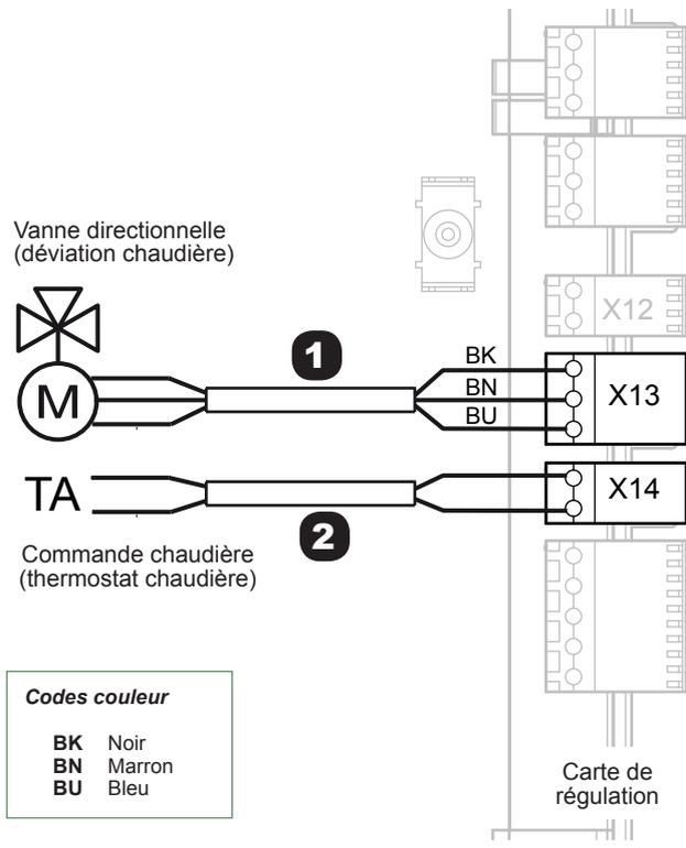
fig. 4 - Câblage électrique
