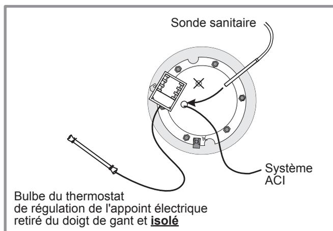
Figure 1 - Logement de la sonde sanitaire (exemple : ballon vertical)
