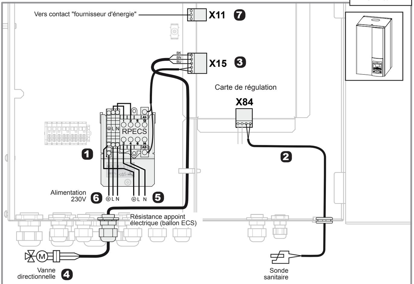
Figure 4 - Raccordements électriques du kit sanitaire
