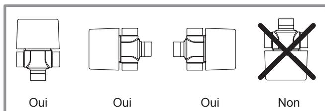
Figure 2 - Positionnement de la vanne directionnelle
